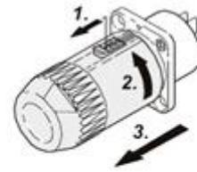
拆卸电源线
