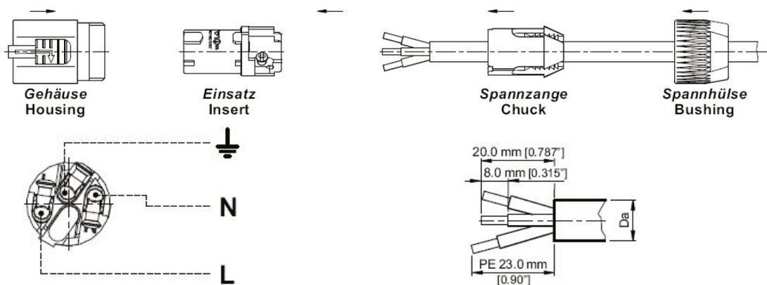
1. 将原电源线插头拆卸下来
