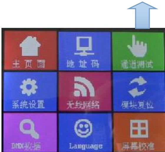
点击 通道调试，能手动控制各通道的数据，如图 E、F、G、H、I 所示，各界面可通过左右翻页转换，要手动控制各功能的 DMX 值，只需在屏幕上划拉滑条到你想要的位置即可
