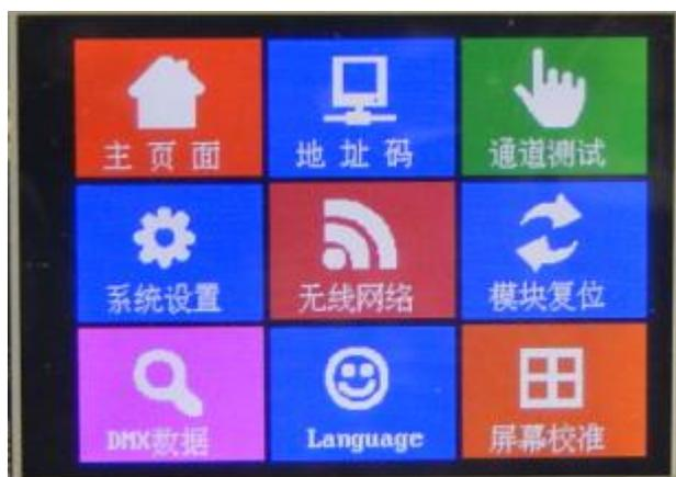
点 地址码 图标，会出现如 C 图所示的界面，在这个界面里您可以设置灯具的 DMX 地址码，设置好后关闭界面时会出现是否保存的提示，如图 D
